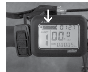
Niveau de la batterie Console de commande numérique
